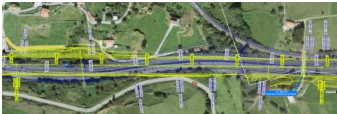
Trazado del tronco de la autovía A-67 del estudio informativo, en color azul, y el trazado propuesto, en color amarillo, entre el P.K. 188+100 y el P.K. 188+800. Se sustituyen tres alineaciones curvas por una recta.
