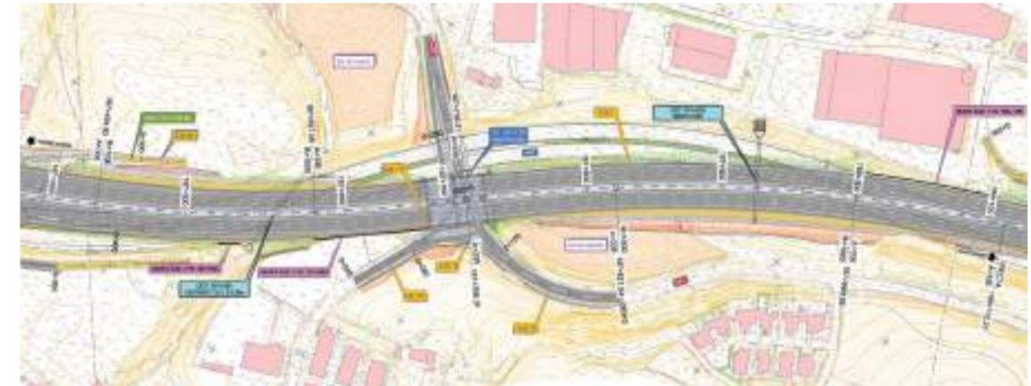
**Trazado del tronco de la autovía A-67 entre el P.K. 186+800 y el P.K. 188+100. Los radios se han ampliado a 1.000 m.**
